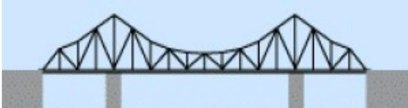
**CANTILEVER THROUGH TRUSS**
