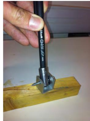
La dernière fixation fonctionne sur le même principe que la précédente : Un manchon est en liaison pivot avec une poutre en U. Le jeu entre le manchon et la poutre est géré à l'aide de deux écrous. Comme précédemment, un ponçage préalable des joncs composites est nécessaire.
