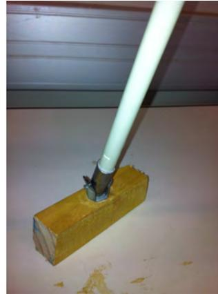
Un manchon métallique est en liaison pivot sur un support sol sur lequel seront ancrées les fixations que nous avons prévues précédemment. La liaison est effectuée à l'aide d'un clou. Afin de fixer les joncs dans le manchon, son ponçage préalable est nécessaire. Ce chemin sera découpé dans deux plaques de contreplaqué de 2,05m x 0,67m. Le tracé au sol est indiqué en bleu sur le plan ci-dessous :
