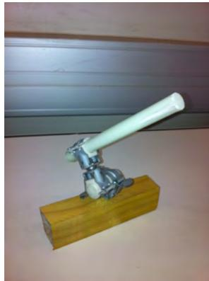
Cette fixation, composée de trois colliers, présente une grande rapidité d'assemblage : il n'est pas nécessaire de poncer préalablement les joncs composites. Toutefois, la position du jonc se trouve sur un cercle de centre la vis et de rayon 2 cm. Il existe donc une imprécision quant à la position du jonc dans l'espace.
