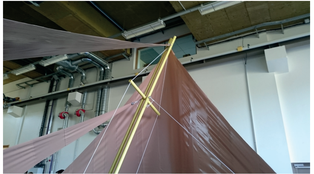
Mât principal, moisé et avec des contre-flèches en composite et drice.
