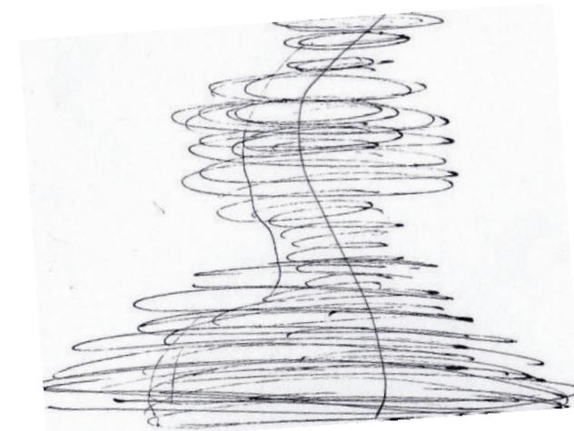
La structure que nous avons conçue repose sur le principe de gridshell rigide. Les croquis ont servi de base à la modélisation avec Grasshopper et Rhinoceros.
