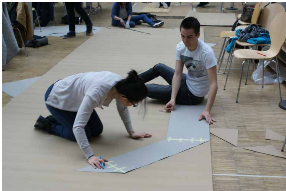
Atelier tracé puis découpe de marches à l'aide d'un patron prédéfini. Etape précise et répétitive.
