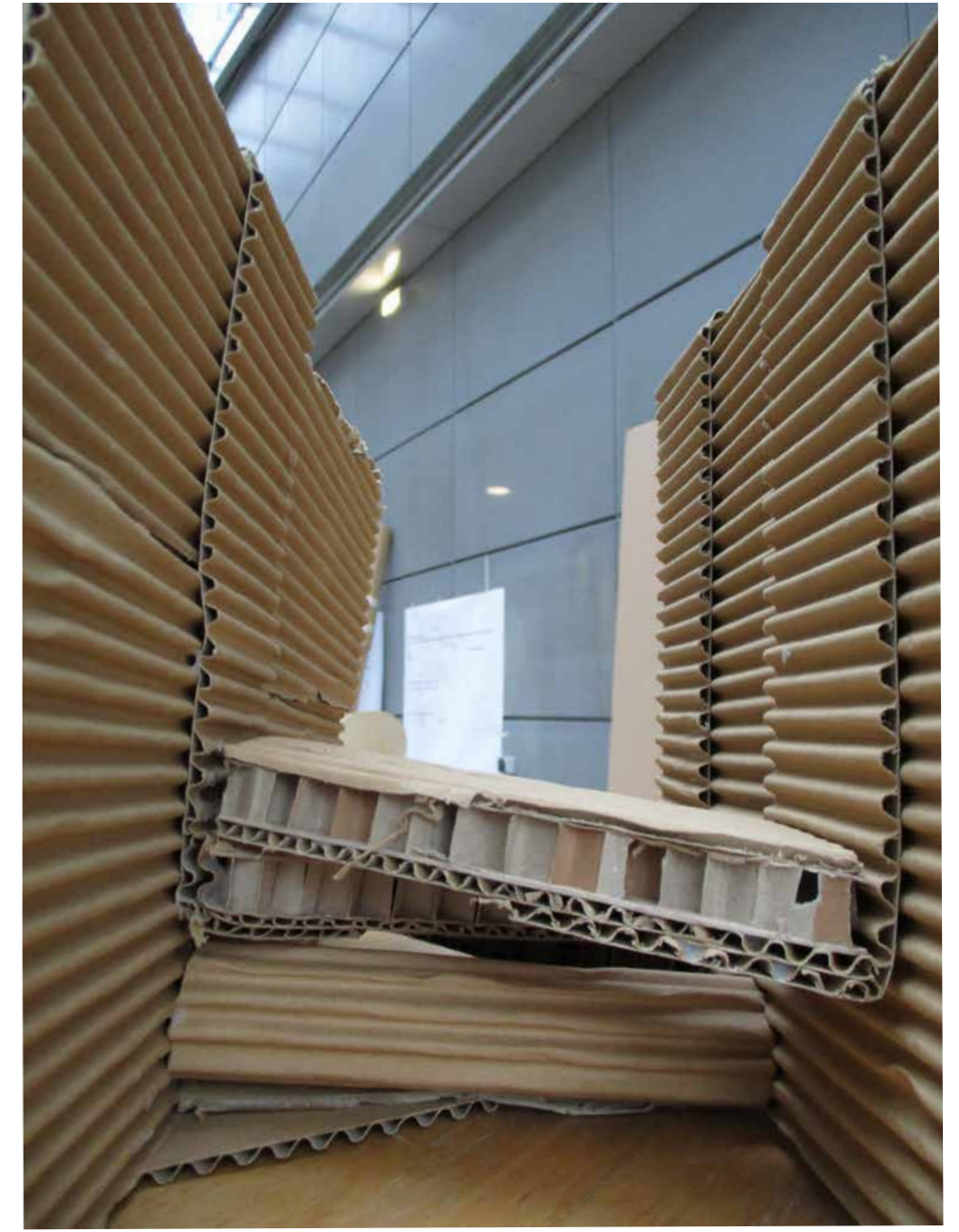
Solution envisagée: bloquer le basculement par un élément comprimé et tendu calé sous les marches entre les garde-corps.
