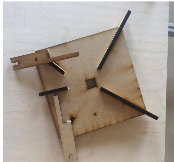
Essai 3 : plaque centrale + pièces d'accroche + cale centrale
