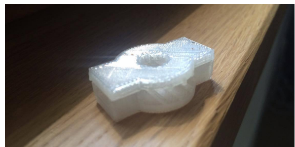
Impression des pions serreurs à l'imprimante 3D Ultimaker 2
