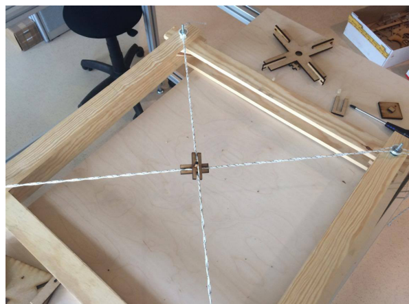
Essai 2 : pièces en H qui permettent d'enrouler les câbles sur eux même
