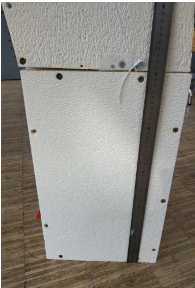
La fixation de la corde et le système de réglage sont identiques : ils consistent en deux émergences de vis côte-à-côte autour desquelles les cordes s'enroulent en 8. Ainsi, les frottements suffisent à fixer la longueur tout en permettant une modification simplifiée par l'absence de nœud. Enfin, les angles par lesquels passent les cordes ont été taillés d'une encoche puis renforcé au ruban adhésif.
